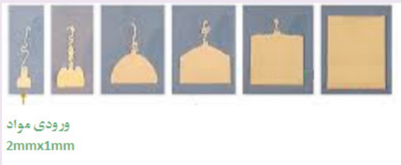
شکل ۲: نحوه پر کردن رزین در طول تزریق
